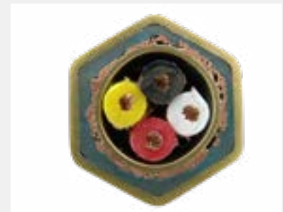
4-adriges, geschirmtes „Twisted-pair“ Datenkabel, Crimpung ohne Trapezeindruck
